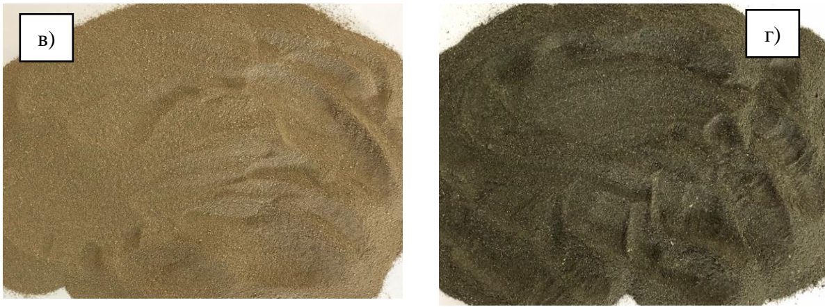
Рис. 3. Фотографии реакционноспособных минеральных порошков: а) окремненный мергель; б) термоактивированный окремненный мергель; в) аспирационная пыль; б) клинкерная пыль
